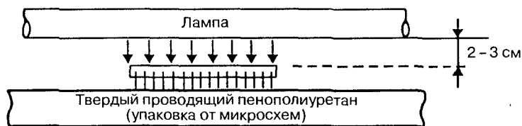
Рис. 2.13. Размещение СППЗУ относительно ультрафиолетовой лампы при стирании
